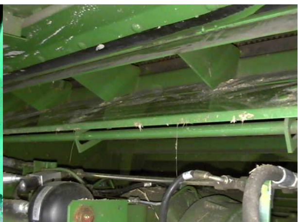
Åpne steinlomma (sett fra undersiden)
